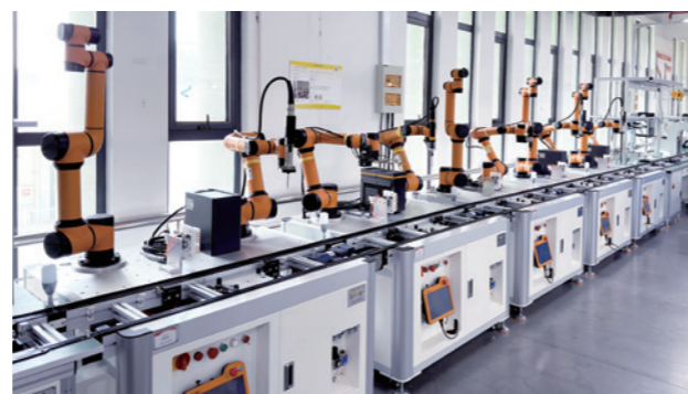
国内首条协作机器人生产协作机器人智能柔性生产线
