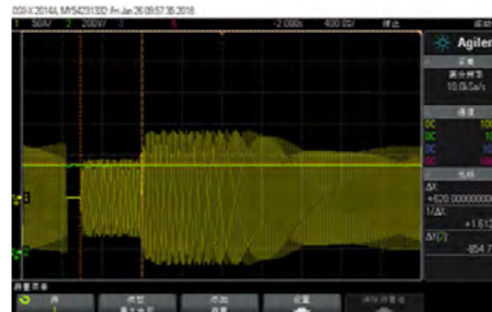
大惯量设备停机时剩磁电压较大，再启动时，可以直接估算出剩磁大小和相位，然后进入旋转中预励磁然后加速
