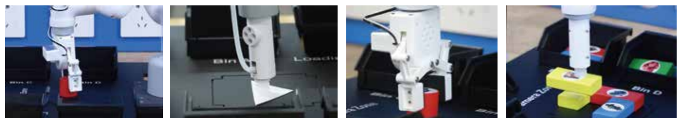
颜色识别 形状识别 YOLOv8识别 拆码垛
