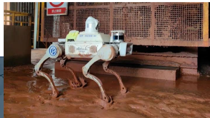
宝钢 原料皮带机通廊巡检
