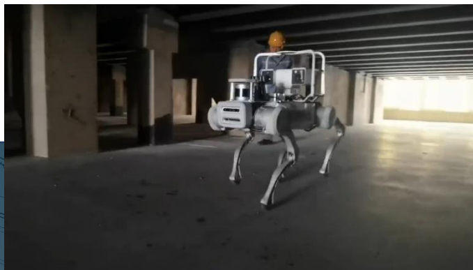
内蒙 某电解铝业电解槽槽底巡检
