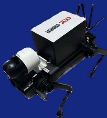
智能远程终端 实现远距离图传与操控
