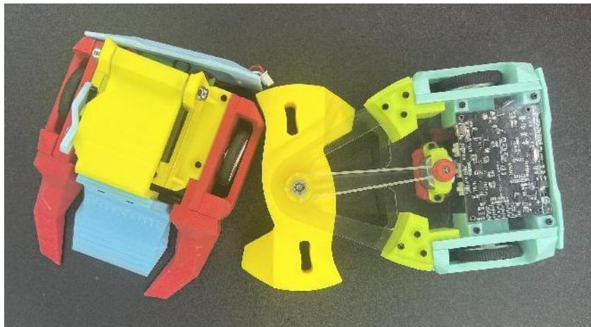
左车电池后盖被右车打开，导致电池线裸露，有短路风险，左车应被判定被 KO
