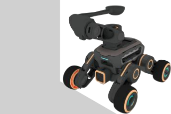
变形车示意图（投掷结构为 3D 打印件）
