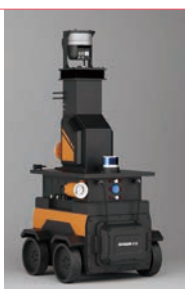
煤矿用井下轮式巡检机器人
