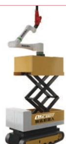
智能建筑打孔机器人
