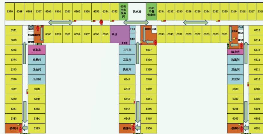
6#号楼3层 四人间 (上下床) 逃生路线 防火门 消防栓 逃生门
